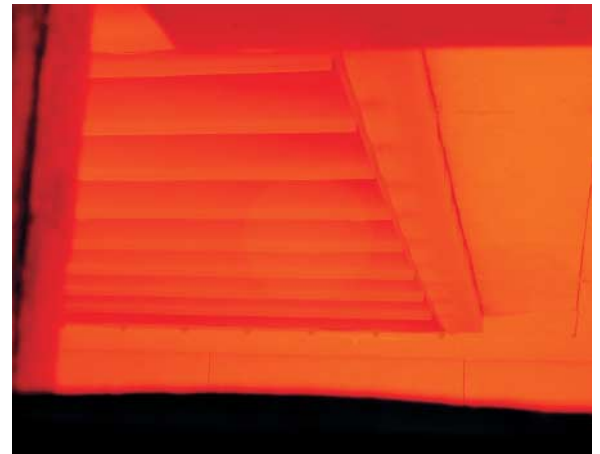
Bild 7: Aufnahme bei 904 °C in der Brennkammer. Wände und Gliederklappe sind nach 30 Minuten gleichmässig hellrot. Physikalische Grenzwerte erreicht?
