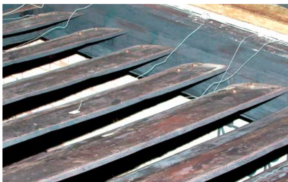
Bild 10: Überraschende Situation nach dem Test von 900 °C: Schwergelprüfte Oberfläche der Klappe, die einzelnen Klappenglieder sind stabil geblieben (kein Pfeilbogen), die (nicht notwendige) Dichtlippe ist wenig verletzt. Die Klappe liess sich bei 900 °C noch schliessen.
