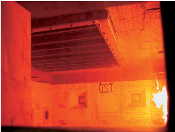
Bild 5: Mehr als je erwartet. Situation nach dem dritten Test bei geschlossener Klappe und 600 °C/10 Minuten. Die einzelnen Klappenglieder widerstanden dank spezieller Konstruktion und Herstellung der Temperaturdifferenz (innen/ausser) von 500 °C!
