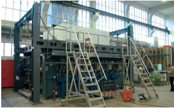
Bild 2: Der grosse Ofen bei der Empa in Dübendorf für Brandversuche bis 1200 °C. Auf dem Ofen wurde eine Betonplatte gegossen (Tunneldecke) und der Montage-rahmen mit der begehbaren Tunnelklappe liegend montiert.
